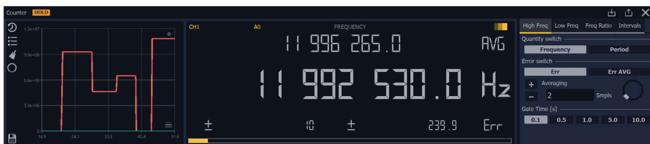
Modul Counter v HF režimu s hlavní hodnotou, historií a ovládacími prvky
