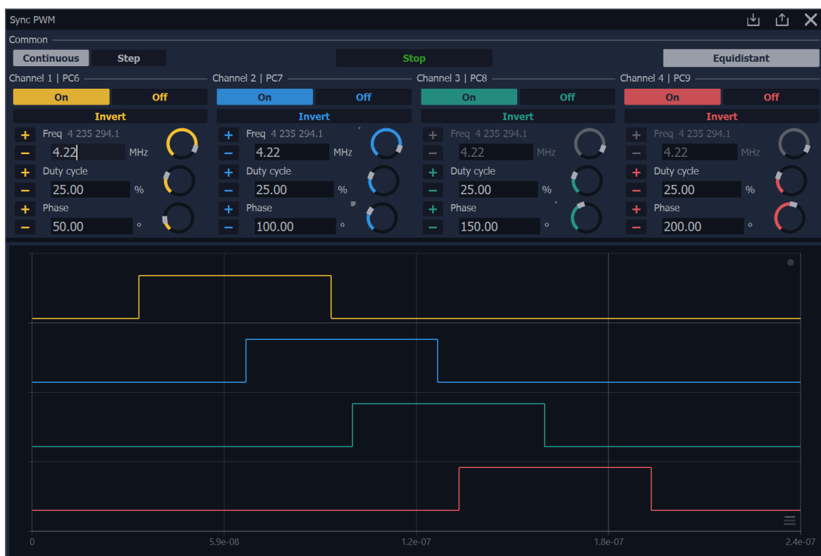
Modul Sync PWM s více kanály a náhledem průběhů
