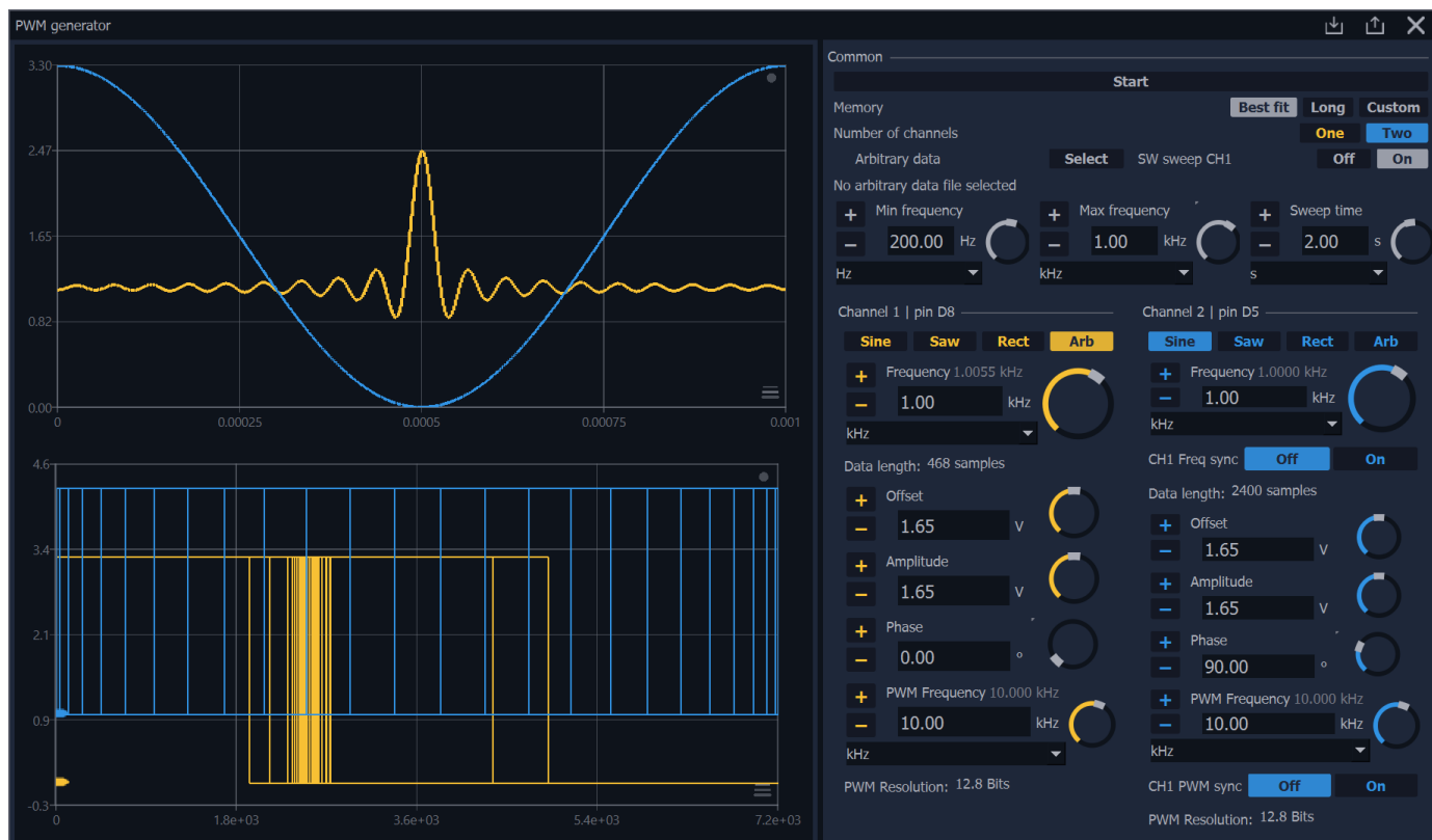
PWM generator se sweepem a specifickým nastavením PWM parametřů
